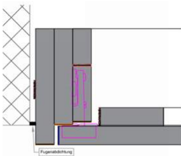
Det. 4 Nischenanschluss mit Abschlusseite
