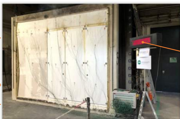
Brandprüfung Noriflamm Compact EI60 RF1
